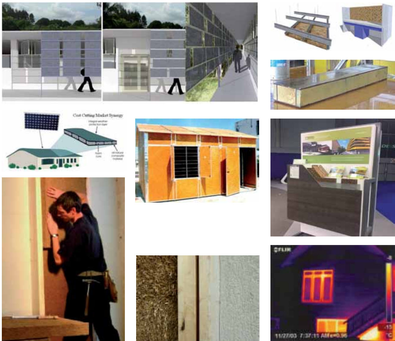
Figura 10. Algunos ejemplos de aplicaciones de biocomposites en el sector de construcción: modelos de fachada con paneles de resina de poliéster insaturado y fibras naturales (a); modelo de falso techo y escritorio con paneles de fibra de pasto y resina fenólica (b); panel monolítico elaborado a partir de bioresinas y fibras naturales (c); refugio temporal elaborado a partir de paneles de mat de bambú y cáscara de arroz (d); prototipo de fachada ventilada desarrollado en el marco del proyecto OSIRYS (e); paneles con cáñamo para el aislamiento térmico de casas (f).
